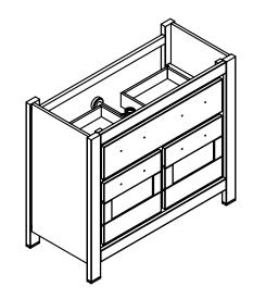
Área de instalación válvulas y desagües Installation area for water connections Zone d'installation des bondes et siphons Einbau Bereich für Ablaufgarnitur und Siphon
